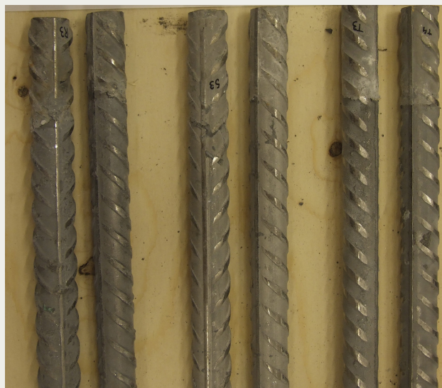
Figur 2. Rostfria bergbultar exponerade två år i Äspötunnelns bergvägg.
