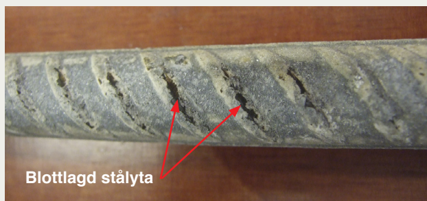
Figur 3. Varmförzinkad bergbult där zinksjiktet är fläckvis bortkorroderat lokalt efter två år i Äspötunnelns bergvägg.
